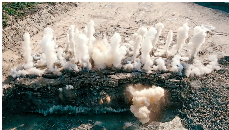
Karjeruose sprogdinimo būdu purenamos dolomito ir klinčių uolienos
